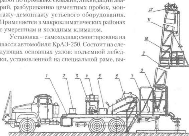
Рис. 5.46. Подъемная установка УПА - 50:
