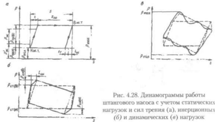
Рис. 4.28. Динамограммы работы штангового насоса с учетом статических нагрузок и сил трения (а), инерционных (б) и динамических (в) нагрузок
