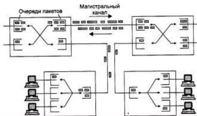
Рисунок 45. Сглаживание пульсаций трафика в сети с коммутацией пакетов
