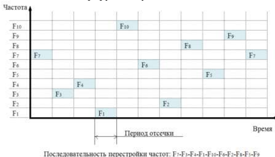
Рисунок 59. Расширение спектра скачкообразной перестройкой частоты
