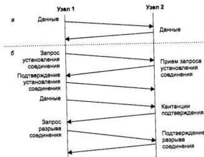
Рисунок 23. Протоколы без установления соединения (а) и с установлением соединения (б)
